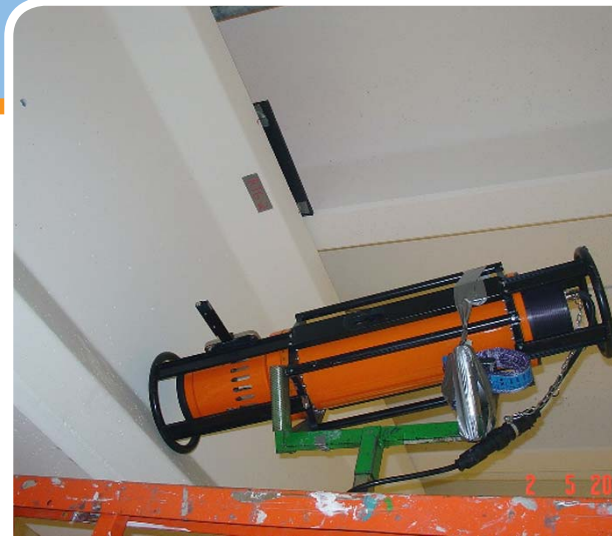
Kuvausjärjestely rakenteiden ainetta rikkomattomassa tarkastuksessa.
